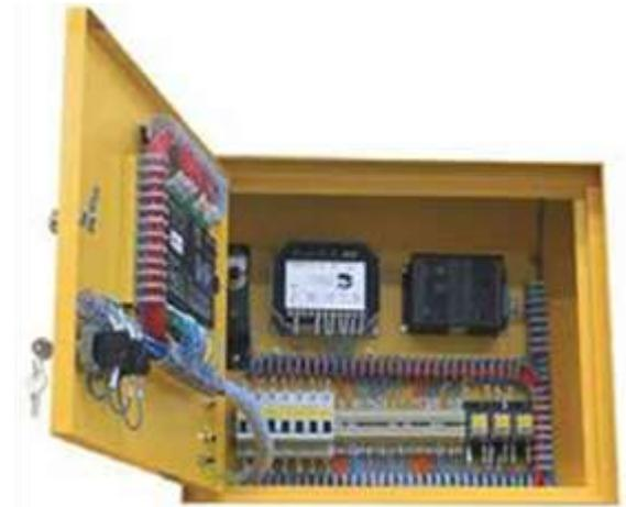
**Deepsea 6120** es un panel de control automático para el generador, puede monitorear y proteger el generador todo el tiempo. Tiene una pantalla LCD que muestra el estado del motor. Este regulador incluye seis entradas y seis salidas. Puede ser desde controlado usando el panel central o la configuración DSE Suite PC del software.
